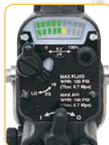
Displej Smart Priamo na pištoli vidíte aktuálne napätie a prúd
