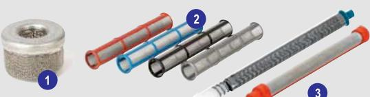
Filtre odstraňujú nečistoty zo striekacieho systému. Konštrukcia nášho EasyOut filtra usmerňuje prúdenie farby zvnútra von a týmto spôsobom efektívne zachytáva akékoľvek nečistoty a zaschnuté zvyšky farby.
