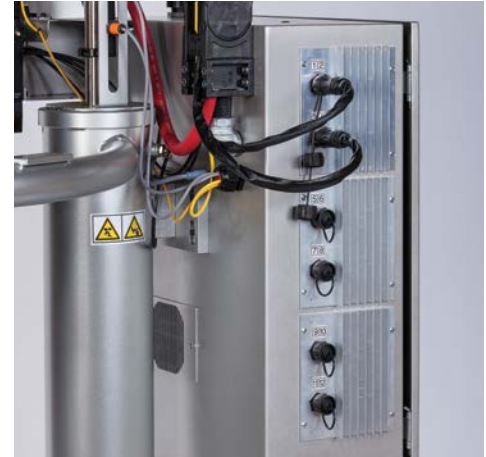
Šesť napájacích bodov pre 12 zón ohrevu definovaných zákazníkom.
